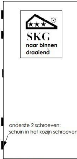
schroefmaten: Ø4.5mmx45mm in hardhout
